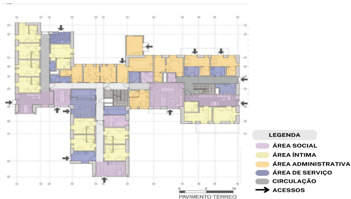
Figura 6 - Planta baixa primeiro pavimento
