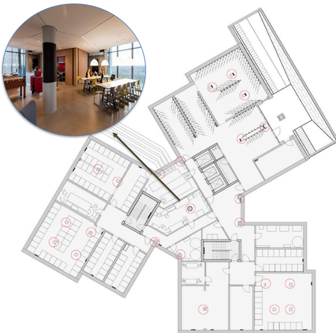
Figura 23 - Planta Subsolo - Localização dos pilares
