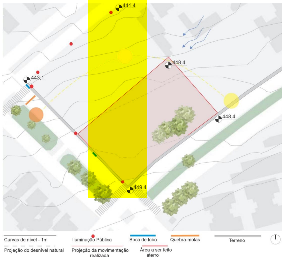
Figura 36 - Movimentação das curvas para aterro no terreno.
