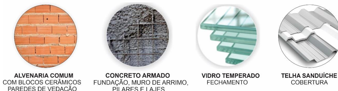
Figura 73 - Sistema Construtivo: Alvenaria comum, concreto armado, vidro temperado e telha sanduíche.
