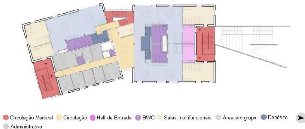
Figura 28 - Planta baixa do segundo pavimento
