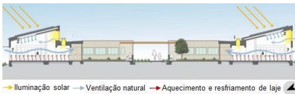
Figura 12 - Corte longitudinal do bloco residencial
