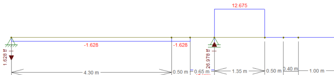
Figura 19: Reações de apoio da carga P.
