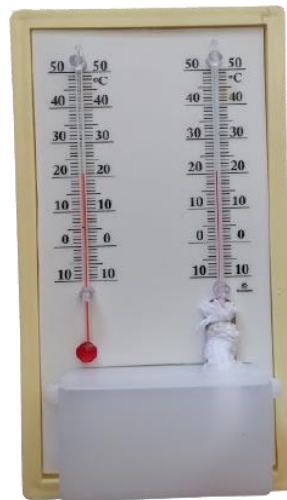
Figura 6: Termômetro de bulbo seco e bulbo úmido utilizado no estudo.
