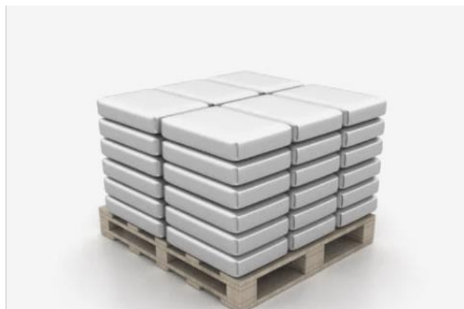
Figura 02: Ilustração de sacos de cimento armazenados sobre estrado de madeira.
