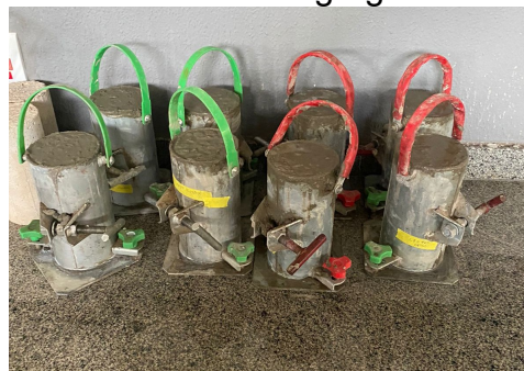
Figura 12: Corpos de prova de concreto 100% de agregado natural. Corpos de prova de concreto com 25% de agregado reciclado
