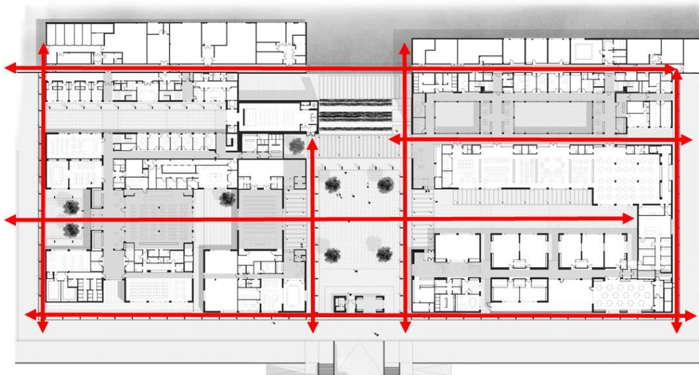
Figura 36 – Eixos de circulações lineares que permeiam o projeto Instituição de Caridade Padre Rubinos .
