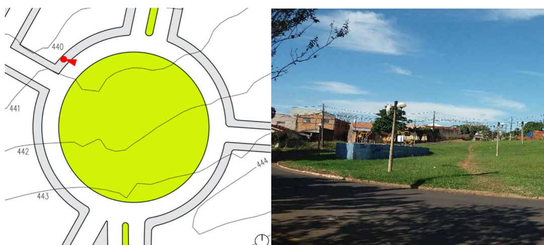
Figura 24 – Drenagem natural em cota menor
