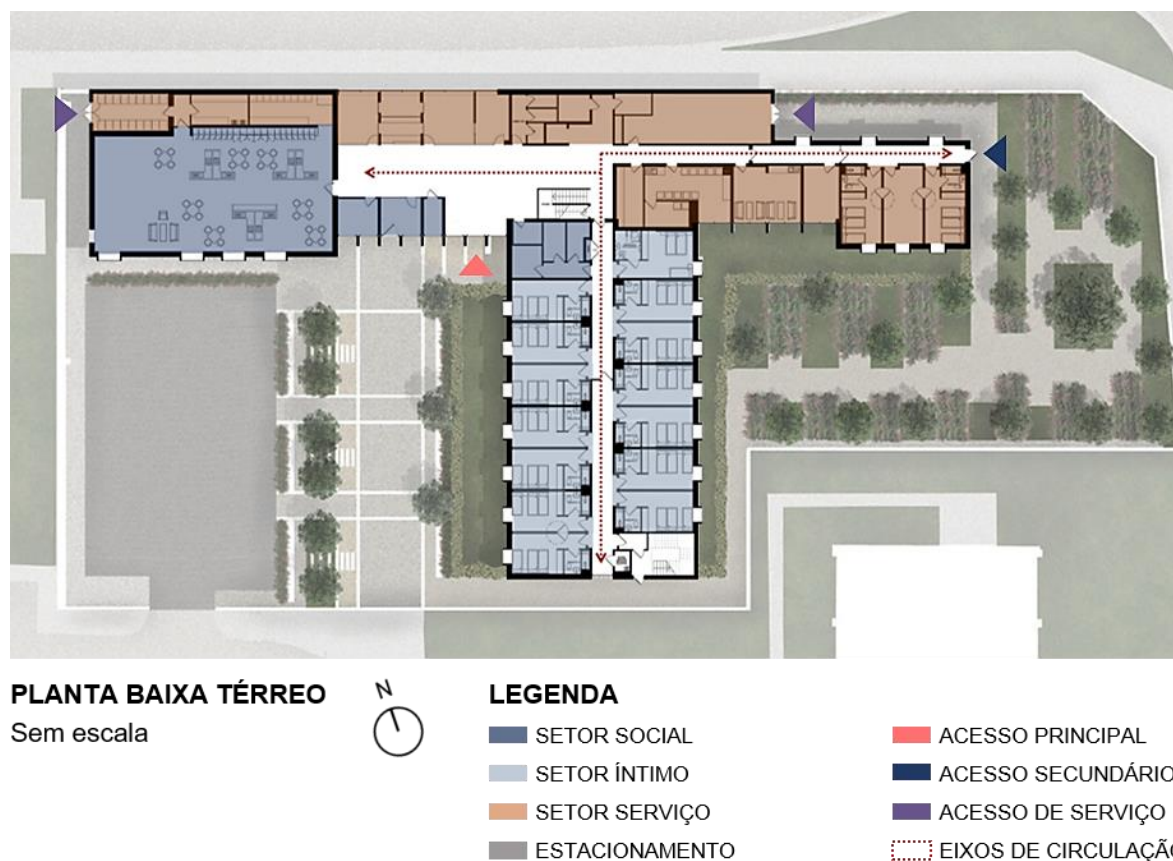
Figura 04 – Planta baixa pavimento térreo setorizada.
