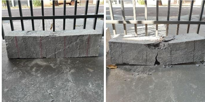
Figura 19: (a) Viga de PRFV rompida e (b) Viga de aço rompida
