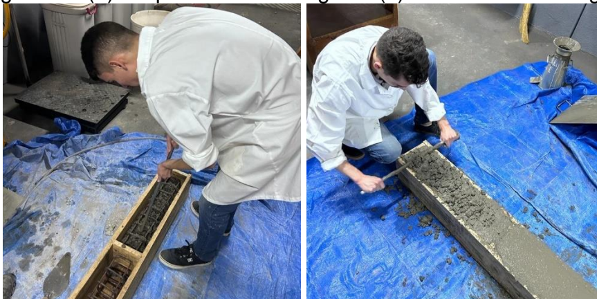
Figura 13: (a) Golpeamento das vigas e (b) Rasamento das vigas
