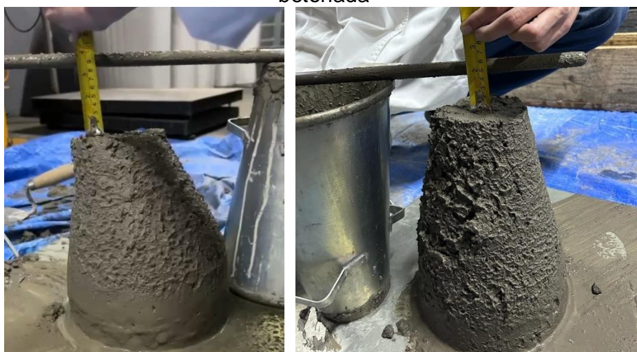
Figura 18: (a) Abatimento do concreto na 1ª betonada e (b) Abatimento do concreto na 2ª betonada
