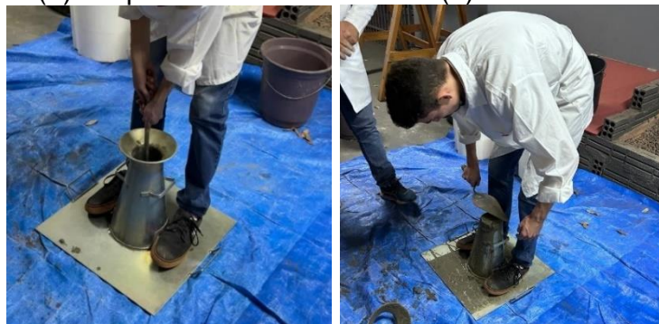
Figura 11: (a) Golpeamento da amostra e (b) rasamento da amostra
