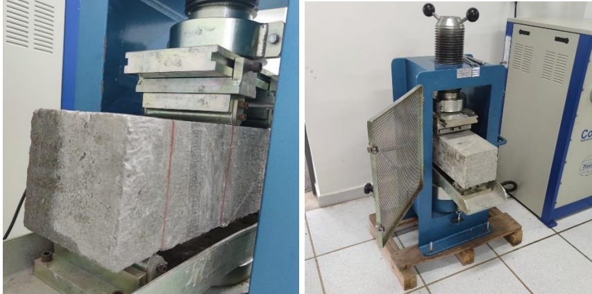
Figura 17: (a) e (b) Viga sendo ensaiada no equipamento
