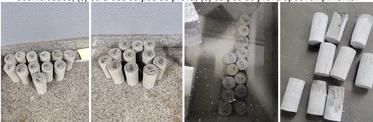
Figura 12: (a) corpos de prova de 7% desmoldados; (b) corpos de prova de 10% desmoldados; (c) cura dos corpos de prova; (d) corpos de prova após rompimento.
