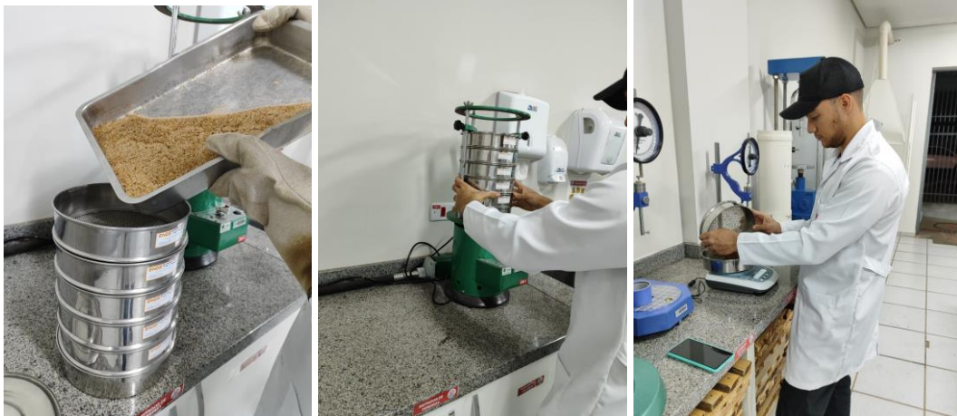
Figura 06: (a) inserindo a areia nas peneiras; (b) agitador mecânico; (c) Pesagem do material; (d) materiais após o peneiramento.
