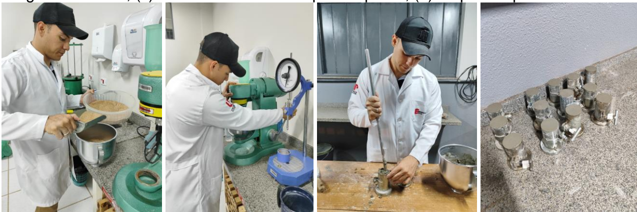
Figura 11: (a) confecção da argamassa; (b) argamassa em preparação na argamassadeira; (c) adensamento dos corpos de prova; (d) corpos de prova no molde.
