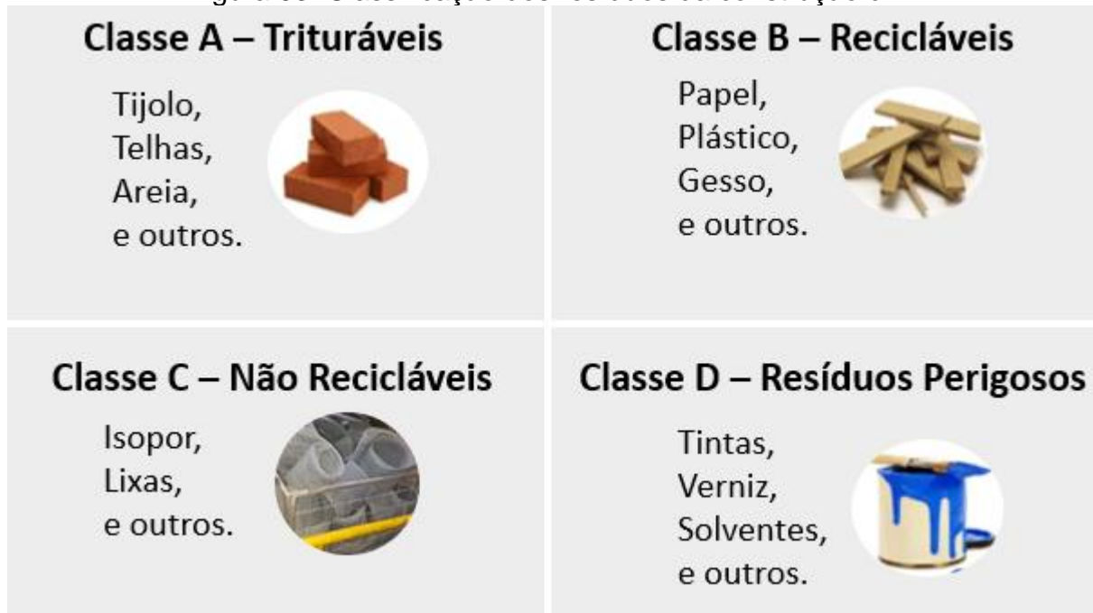
Figura 03: Classificação dos resíduos da construção civil
