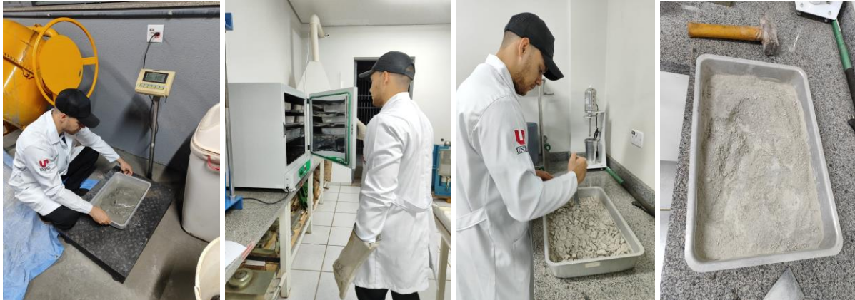
Figura 10: (a) pesagem do resíduo de rochas ornamentais; (b) secagem dos agregados em estufa; (c) preparação do resíduo de rochas ornamentais; (d) resíduo de rochas ornamentais pós preparação.
