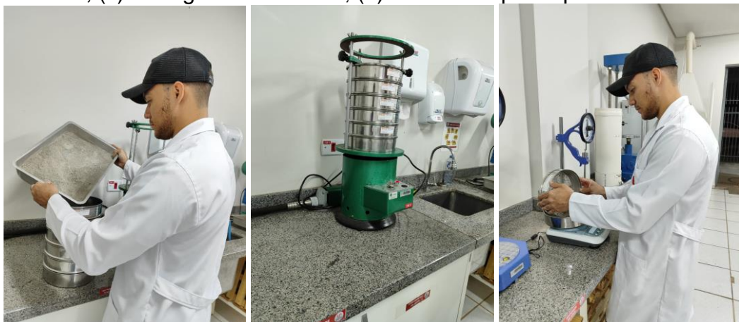
Figura 07: (a) inserindo o resíduo de rochas ornamentais nas peneiras; (b) agitador mecânico; (c) Pesagem do material; (d) materiais após o peneiramento.
