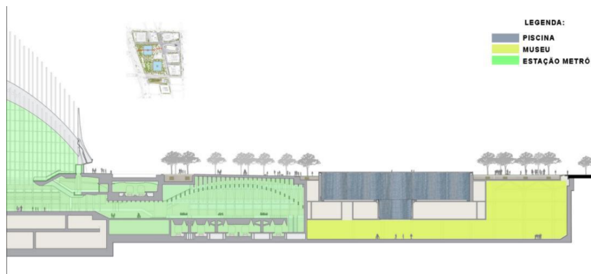
Figura 50 - Corte, Memorial a Estação de Metrô.
